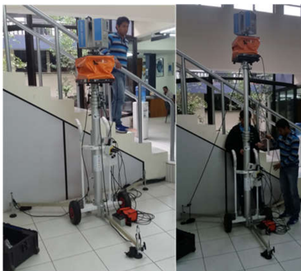
Figura 4. Escaneo sobre Extensión Scan&go
