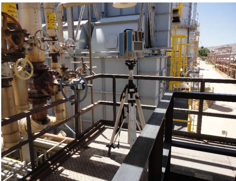
Figura 5. Escaneo sobre trípode en altura sobre plataforma.
