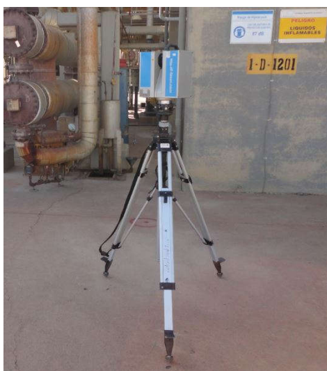
Figura 3. Escaneo sobre trípode a nivel de piso.
